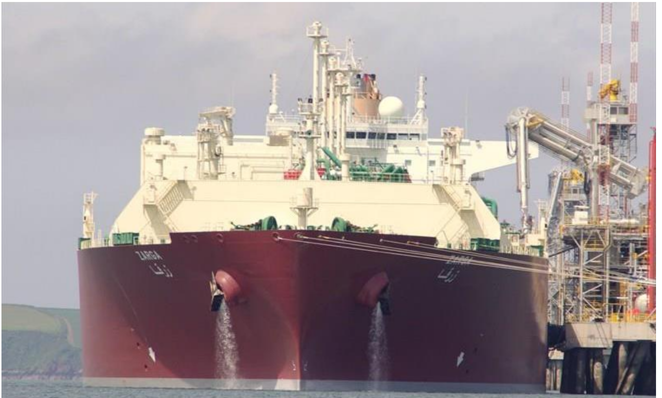
Рисунок 1.1.3.10 – Танкер-газовоз Zarga (типоразмер Q-max) [59]
