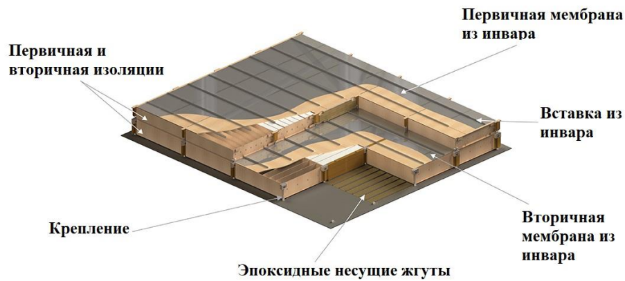
Рисунок 1.1.3.19 – Устройство мембранного танка типа GTT № 96 [66]
