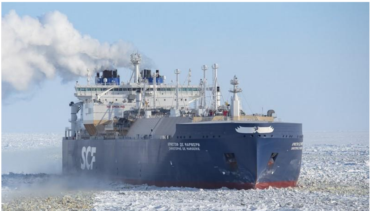
Рисунок 1.1.3.11 – Танкер-газовоз Christophe de Margerie (типоразмер Yamalmax) [59]
