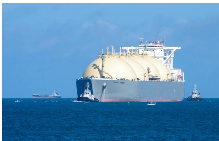
Рисунок 1.1.3.13 – Крупнейший танкер-газовоз Pacific Breeze с танками типа Moss [59]
