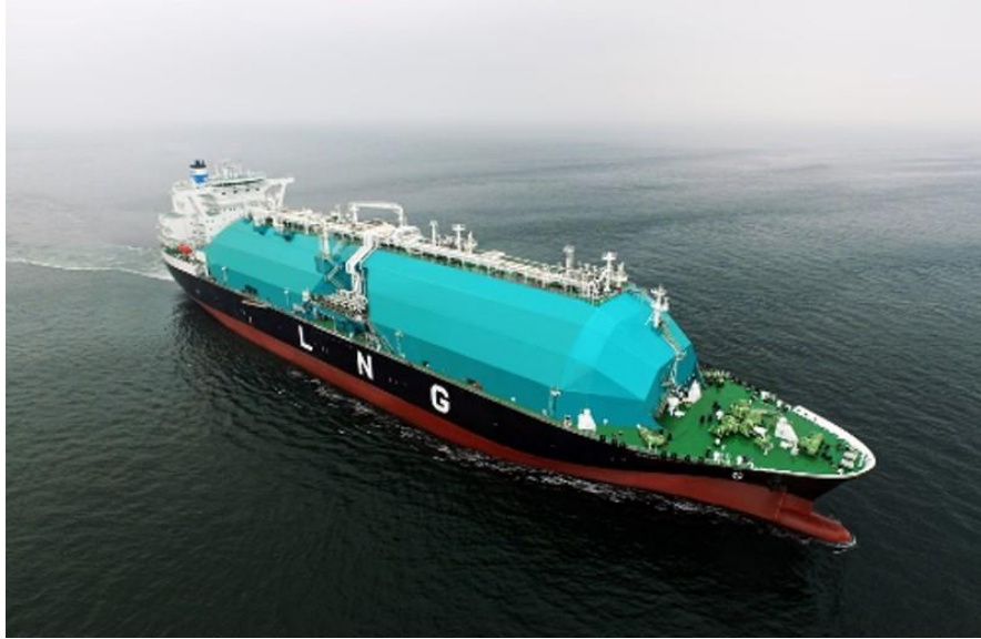
Рисунок 1.1.3.14 –Танкер-газовоз Seri Camellia с несферическими танками типа Moss [59]
