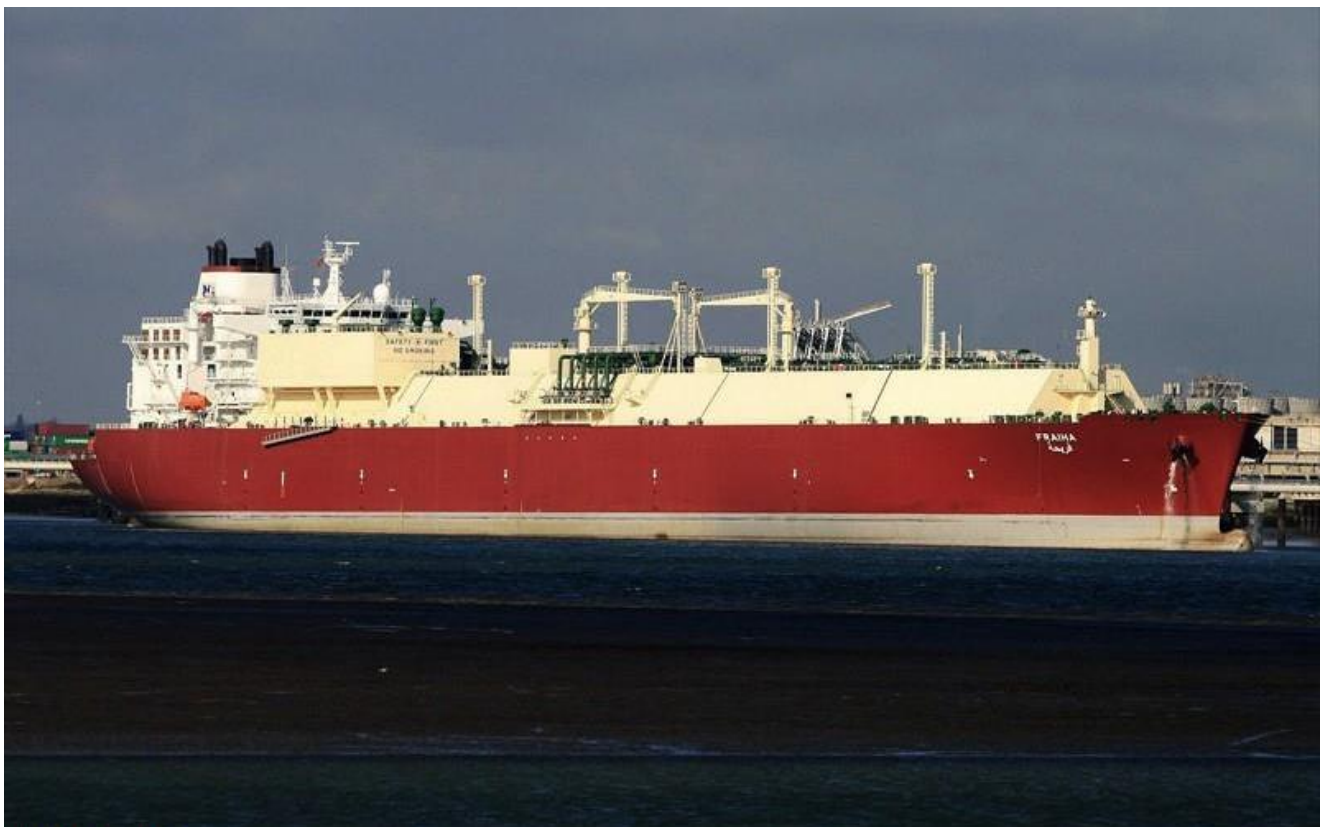
Рисунок 1.1.3.9 – Танкер-газовоз Fraiha (типоразмер Q-Flex) [59]
